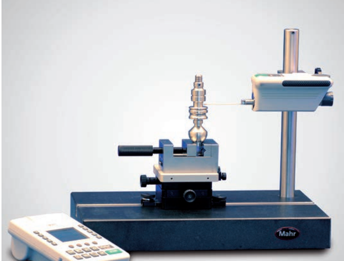
ST-G ölçüm standıyla birlikte MarSurf ölçüm istasyonu
