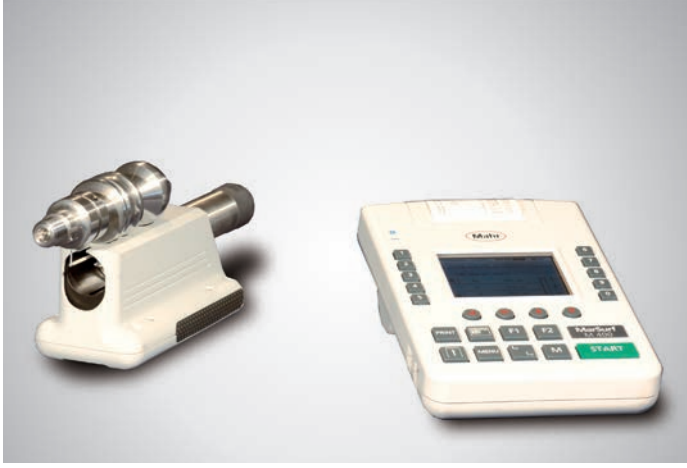
Vee bloğuyla baş aşağı ölçüm BFW 250 otomatik sıfırlama ayarı
