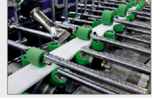
SARMA MODÜLÜ WRAPPING ZONE ЗОНА ОКУТЫВАНИЯ
