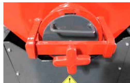
Media unloading unit.
