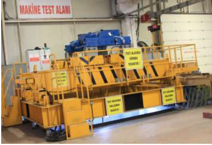
Kaldırma Makinası Test Alanı (60.000 kg ya kadar)
