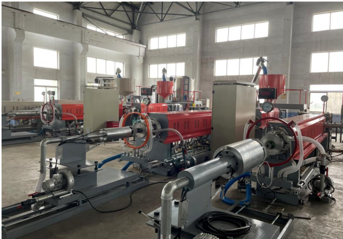
PS foam sheet extrusion line110/130 型 PS 发泡片材生产线包括以下主要部分
