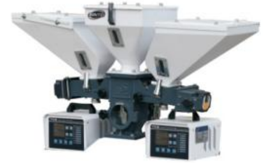
TCM-D双色计量式色母混合机 TCM-D double-color volumetric dosers
