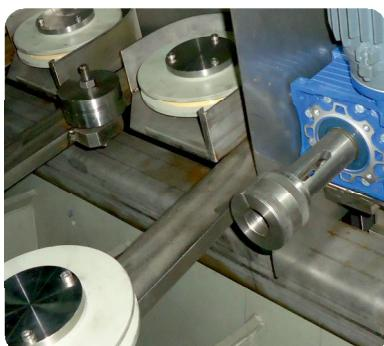
**TR** Tel bakırlama havuzu, daldırma şeklinde kaplama yapan bir sistemdir.
