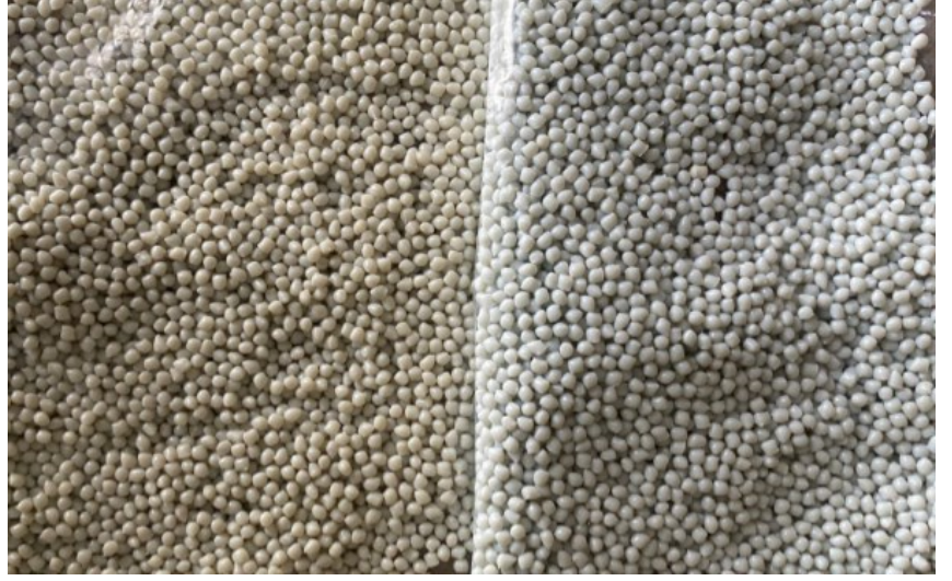
Şekil 3: Katkısız PET Flake ile 0,5% PEGUARD Katkılı oluşan görüntü
