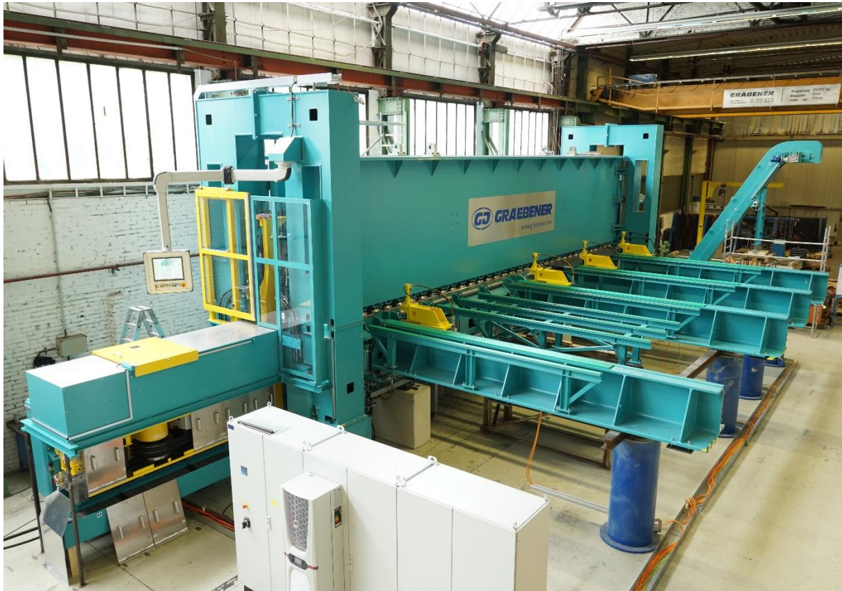
Graebener Plattenfräsanlage Einlaufseite.jpg
