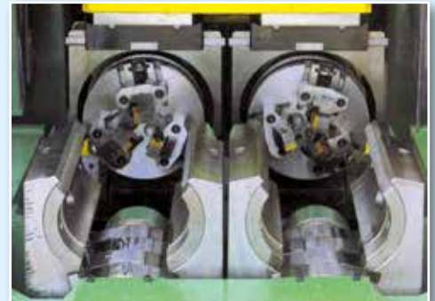
Doppia testa di smussatura e morse serraggio tubo Double bevelling head and tube clamps
