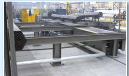
Catenarie di stoccaggio Chain storage
