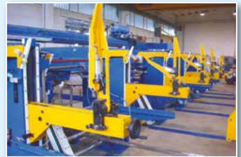
Dettaglio formazione pacco Bundle forming detail
