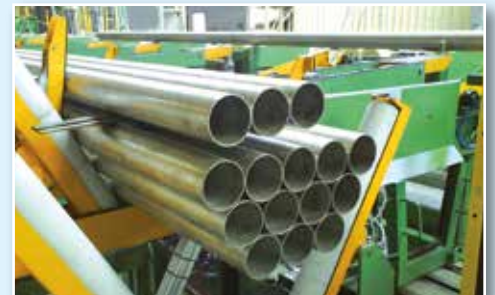
Formatura del pacco esagonale Hexagonal pack molding
