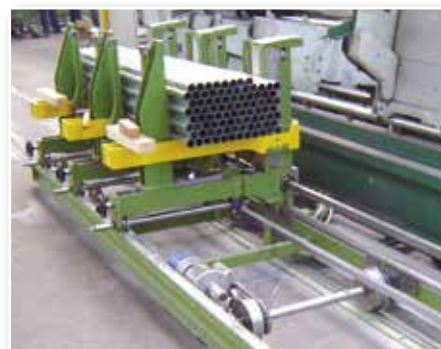
Cesta di raccolta Collecting tubes basket
