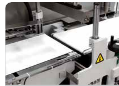
Kir birikmesini engellemek için tasarlanmış yapıştırma kafası
