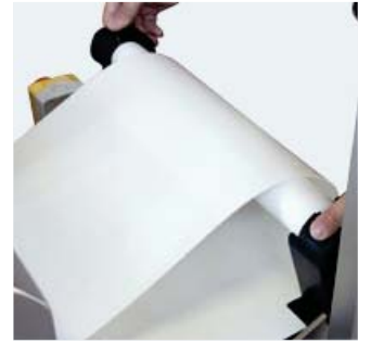
TEMİZLİĞİ VE KONTROLÜ KOLAY: TEKNİK ALETLER OLMADAN KONVEYÖR BANT SÖKÜLÜP TAKILABİLİR.
