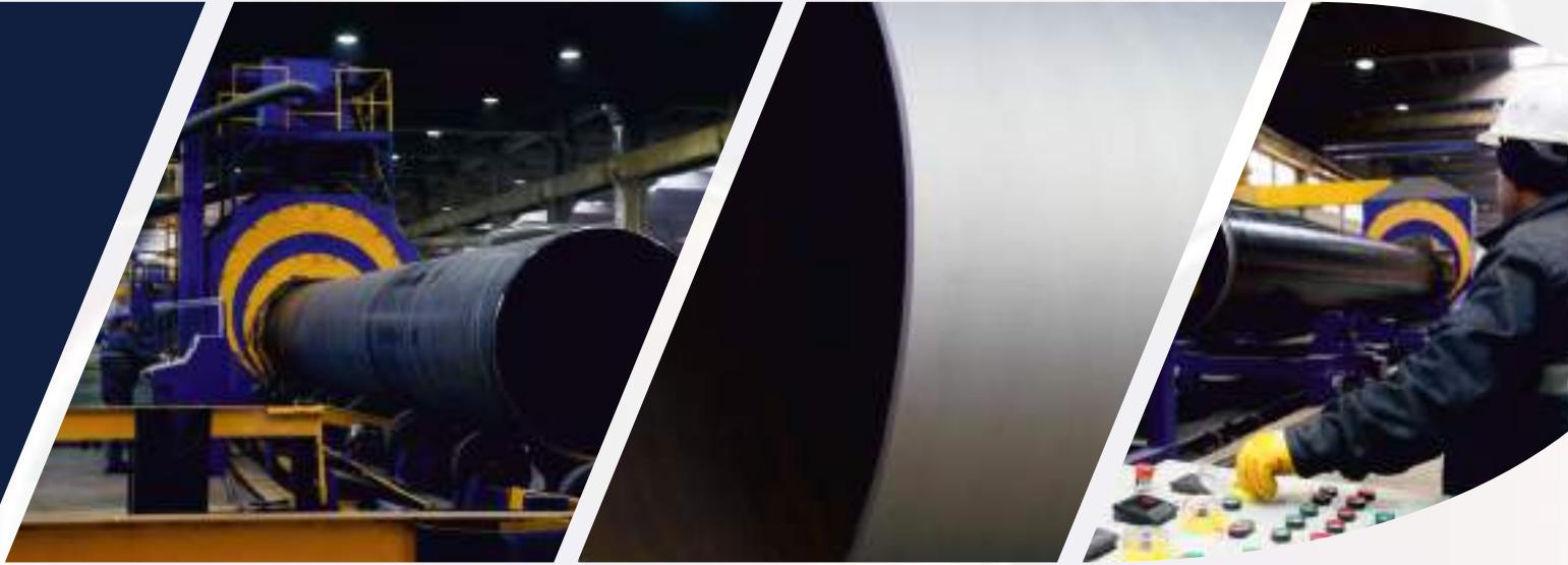
Çıplak olarak tahribatlı ve tahribatsız tüm kontrollerden geçen borular, kaplama öncesinde yüzeylerindeki pas, toz, tufal, yağ gibi dış etkenlerden temizlenir. Bu amaçla boru iç ve dış yüzeyleri kumlama hattına alınır ve çelik granül ile DIN 55928 veya ISO 8501/01 standartına uygun olarak Sa 2 1/2- Sa3 kalitesinde otomatik makinelerde kumlanır. 50 -90 mikron arası yüzey pürüzlülüğü elde edilir.
