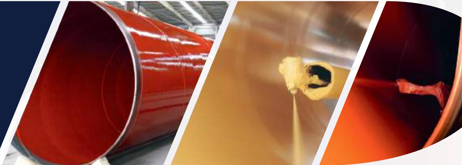
Kumlanan boru otomatik arabalarda istenilen sürat ayarlanarak kendi etrafında döndürülür bu aşamada borunun dönme eksene dik hareket eden bir arabanın ileri-geri hareketi vasıtısıyla borunun içine veya dışına pompalar ile boyaya püskürtülür.
