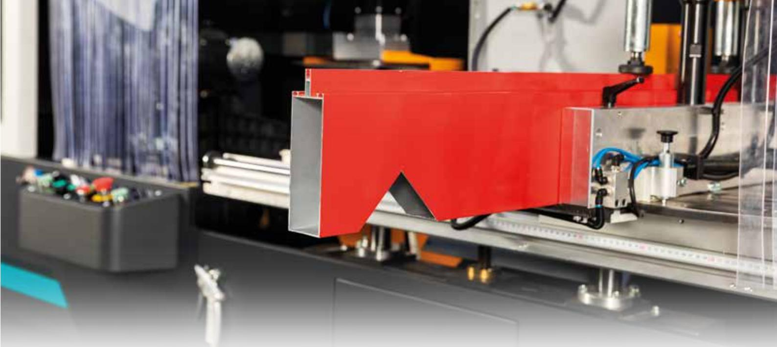
**SNM 560SRV** her türlü cephe kaplama, kış bahçesi uygulamaları, aydınlatma pencereleri ve özel uygulamalarda kullanılan PVC ve alüminyum kasa, kanat, orta kayıt ve lento profillerine istenilen açı ve ölçüde boşaltma işlemi yapmak amacıyla tasarlanmıştır. Kesilecek profil makine tablosu üzerine sabitlenerek ve 2 adet testerenin bağlı olduğu hidro-pnömatik kesme unitesi otomatik olarak hareket ederek kesme ve boşaltma operasyonları yapılmaktadır.
