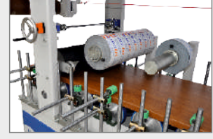
KORUYUCU BANT KAPLAMA İSTASYONU PROTECTIVE TAPE WRAPPING STATION УЗЕЛ НАНЕСЕНИЯ ЗАЩИТНОЙ ПЛЕНКИ
