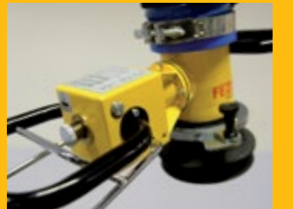
Blower çalıştırmak / kapamak amaçlı uzaktan kumanda
