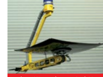
Parçaların 180° yatar duruma getirmek için pnömatrik döndürme ünitesi
