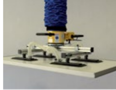
Travers üzerinde ayarlanabilir dörtlü emiş vantuzu
