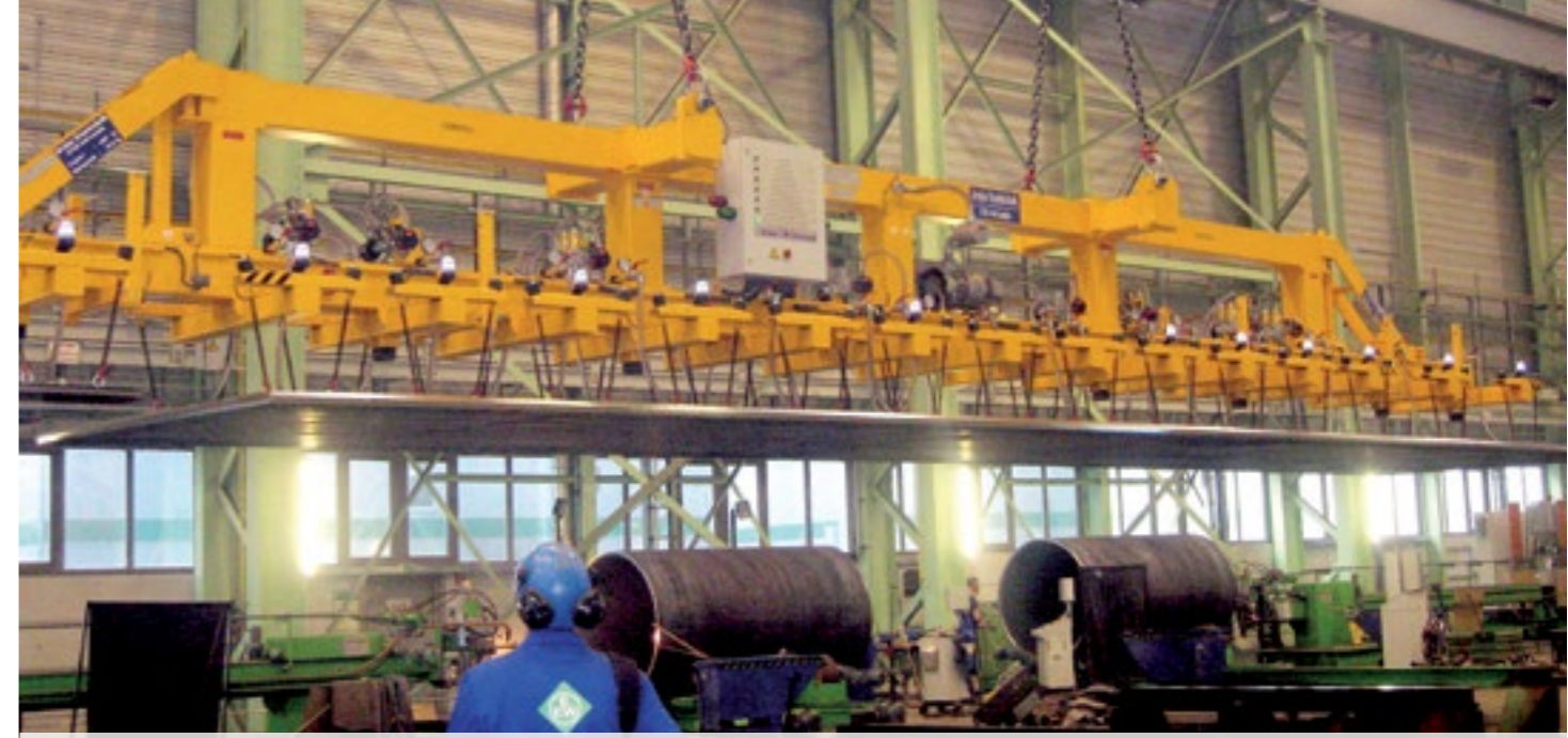
40.000 kg'lık çelik levhanın taşınmasında VacuGiant kullanımı
