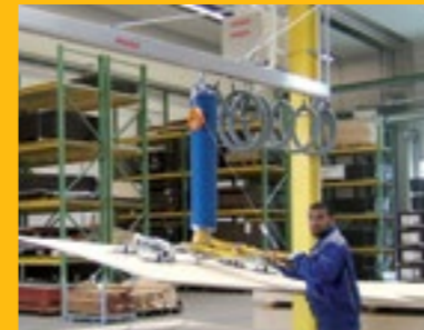
Kumanda kolunu dengelemek için ek uzantılar
