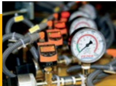
Dijital vakum şalterleriyle her emiş odacığındaki vakum seviyesinin kontrolü
