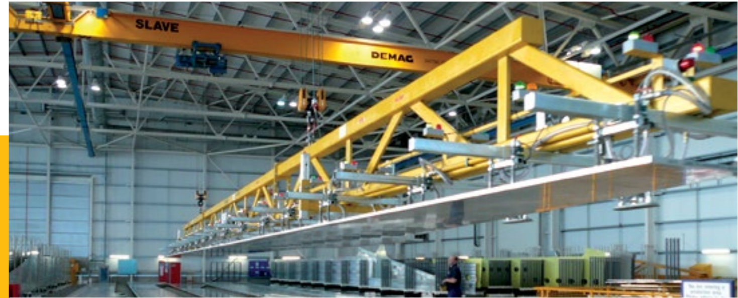
Airbus A380 kanat üretiminde 36 m uzunluğunda 4.500 kg ağırlığındaki alüminyum plakanın VacuGiant ile taşınması
