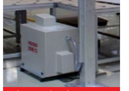
Gürültü seviyesini düşürmek için susturucu kutu
