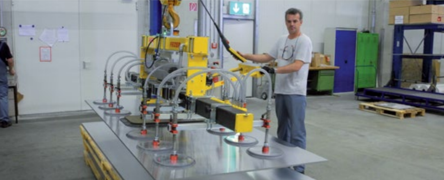
2.000 kg'a kadar VacuBoy ile metal sacların istiflenmesi
