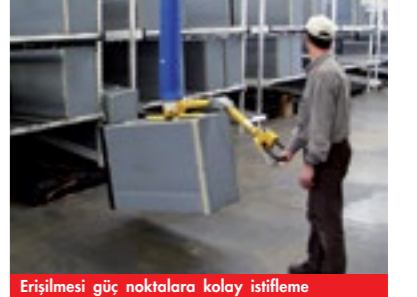
Erişilmesi güç noktalara kolay istifleme amaçlı kumanda ünitesine entegre edilmiş bağlantı parçası
