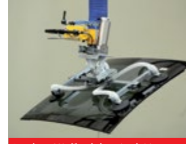
Parçaların 90° dikey hale getirmek için pnömatrik döndürme ünitesi
