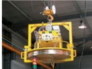
Uzun süreli taşıma işlemleri için mekanik alt kısımdan kavramalı tutucular
