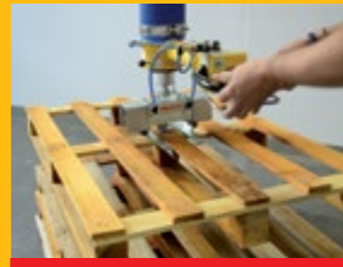
Paleterin taşınması için dizayn edilmiş pnömatrik tutucu
