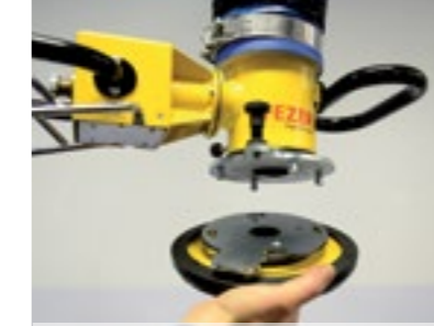
Üretim sırasında ürüne göre hızlı değiştirilebilir adaptör
