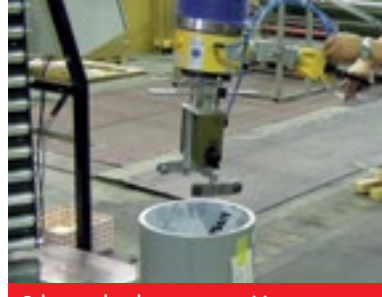
Rulo veya boruların taşınması için pnömatrik tutucu
