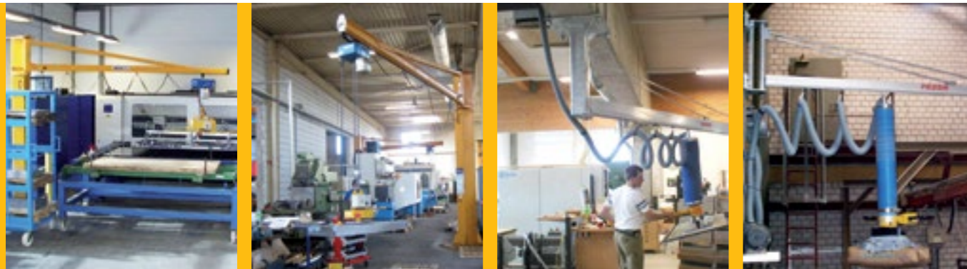
Firma çalışma alanına özel tek kirişli alüminyum vinç sistemi
