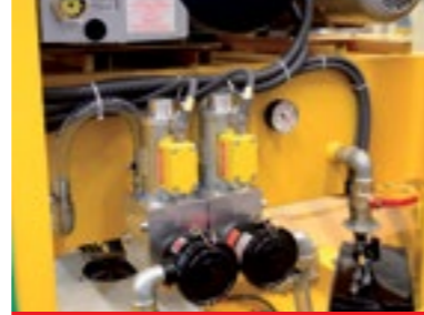
Solenoid valfler üzerinde vakum amaçlı emiş odacıklarının kontrolü
