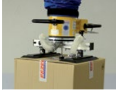
Travers üzerinde ayarlanabilir ikili emiş vantuzu
