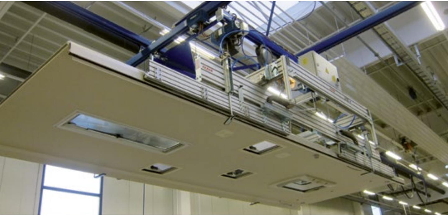
Mobil karavan üretiminde pnömatik sistemle entegre edilmiş ve malzemelerin kenar kısmından emiş sağlayan vantuzlarla taşıma hattı
