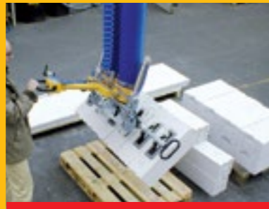
Birden fazla beton blokları eş zamanlı taşımak için dizayn edilmiş emiş vantuzları
