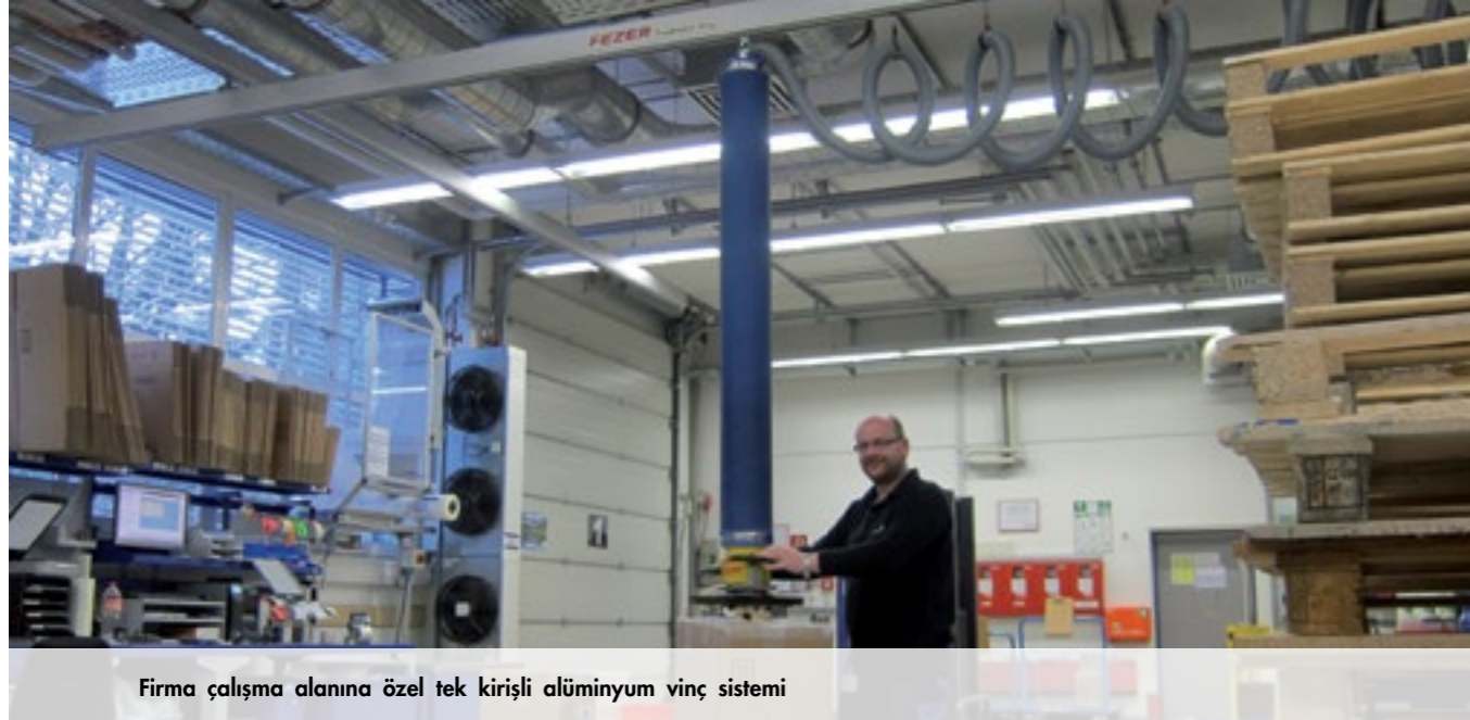
Bosch firması için özel olarak kurulmuş hafif tip pergel vinç sistemleri ve VacuQuicklift
