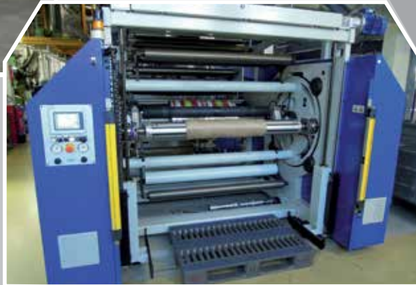
Avvolgitore automatico a disco, tipo DATA-100 con scarico bobine Automatic, flying splice rewinder, type DATA-100 with reel unloading
