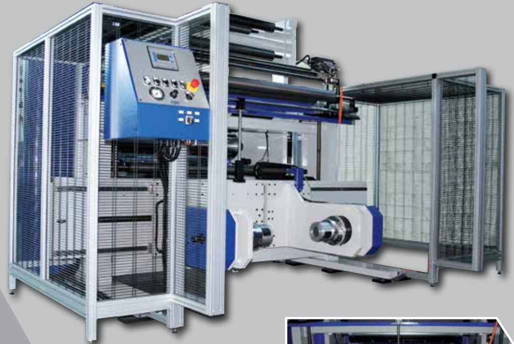
Svolgitore "shaft - less" tipo SSL-130 Shaft - less unwinder, type SSL-130
