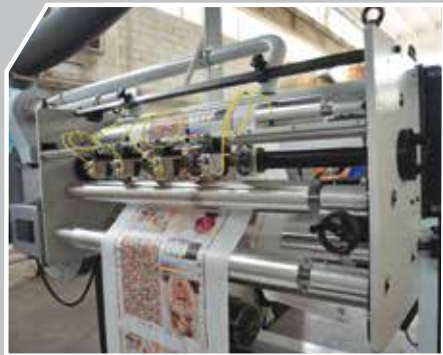
Gruppo taglio longitudinale a lama circolare Longitudinal, circular blade cutting unit
