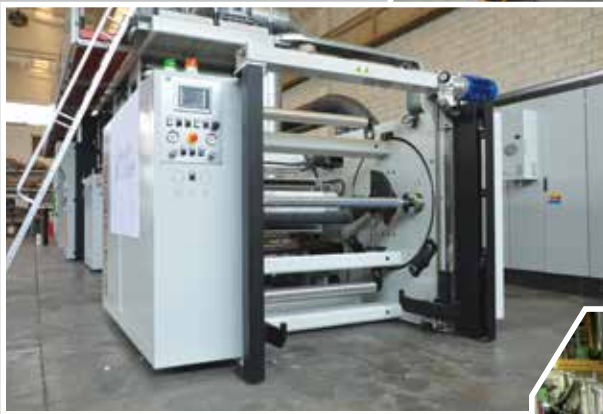
Avvolgitore automatico a disco, tipo DATA-80 Automatic, flying splice rewinder, type DATA-80
