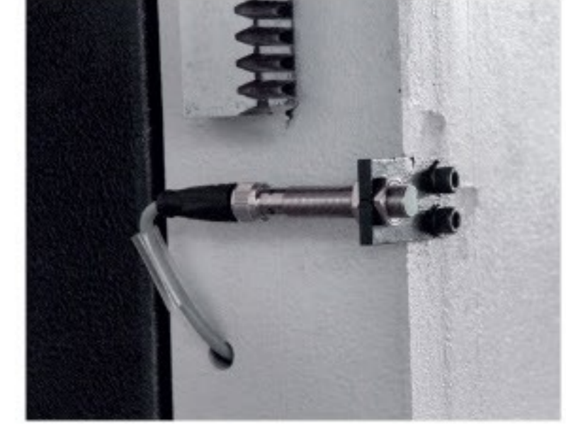
Aşağı-Yukarı Limit Sensörleri (Sensör Arızalarına Karşı Oransal Koruma) Up-and-Down Limit Sensors (Against Sensor Failures Proportional Protection)
