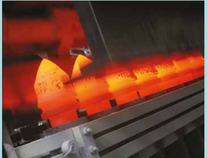
Tungsten karbür ve çeliğin kalıcı olarak birleştirildiği lehimleme süreci
