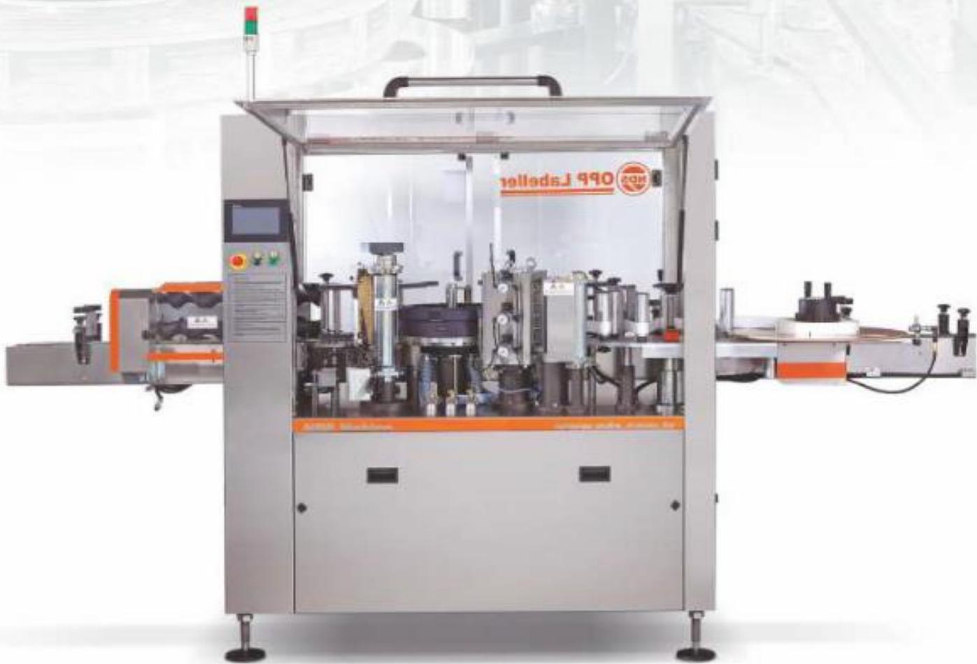
ROLLEXTEM-L line tipi dizaynı ile silindirik şişelere çepçeuvre etiket yapıştırma için tasarlanmış bir makinadır.
