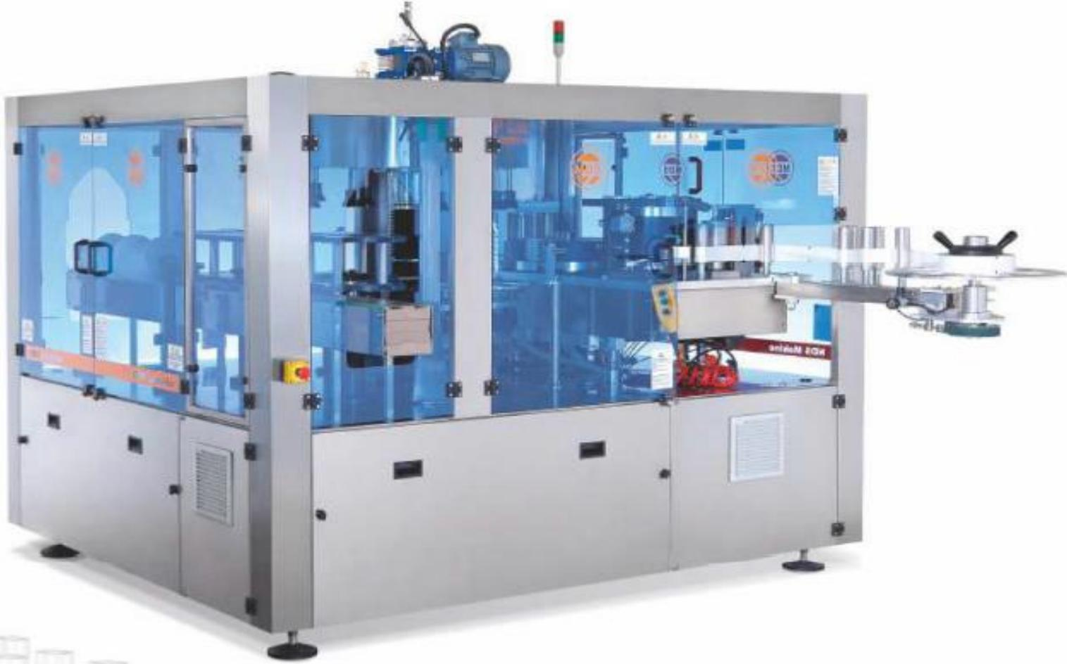
ROLLEXTEM-R döner tip çalışma sistemi sayesinde line tipi makinelere göre daha yüksek verimlilikte çalışmaktadır. Kullanma ve çalışma sistemi çok rahat olup her kişi tarafından rahatça kullanılabilir. 5-10 ve 0.33-2,5 lt arasındaki sigelerin etiketlenebilmesi için iki farklı şekilde üretim yapılmaktadır. İsteğe göre saatte 30.000 şişe/saat hızda üretimi yapılmaktadır.
