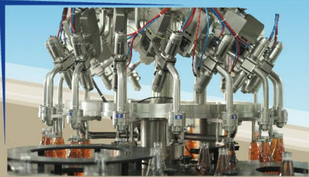
Hijyenik şartlara uygun Makine çevresi ve üst tavanı tamamen kapalı olup, hepa filtreli fanlar ile pozitif basınç yaratarak makine içine toz veya bakteri girmesini önlemektedir. Kapatma grubu monoblock gövde üzerine plastik, alüminyum ve metal kapaklara uygun kapatma grupları montajı yapılabilir ve birden fazla kapak kapatma özelliği talebi üzerine tek şasede üç ayrı kapama grubu montajı yapılabilir.
