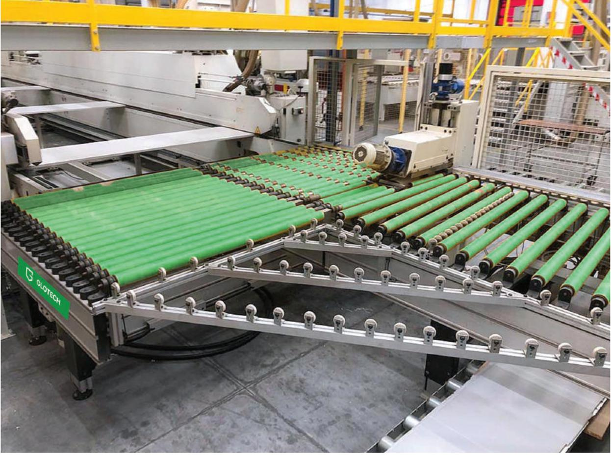
Panel Ebatlama, Kenar Bantlama ve CNC Delik, İşleme Merkezleri Hatlarına entegre olunması için kullanılan bu sistem yükleme-boşaltma ve konveyör sistemlerinden oluşur.
