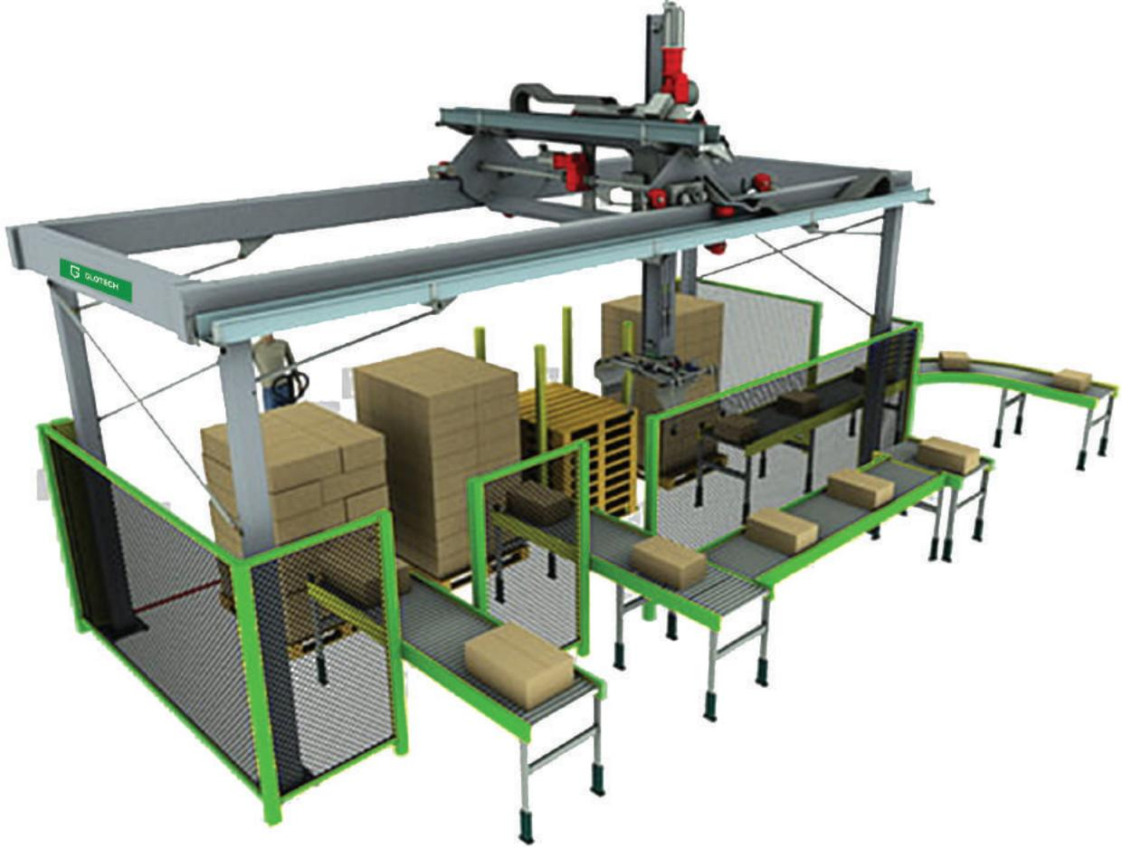
Laminasyon hattında MDF, Compact, Ahşap, Kompozit ve Diğer lamine edilecek panellerin istif sehparlarından hatta beslenmesi için ve boşaltma istasyonu olarak kullanılır. 2 veya 3 eksen hareket mekanizmasına sahiptir.
