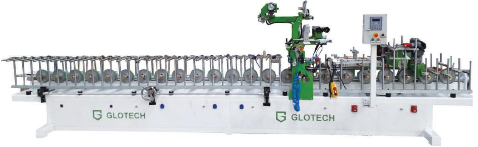
Kasa, Pervaz, Ahşap Profiller üzerine PVC, PP, Kağıt, Mikrolaminant, rulo folyolar kaplamak için kullanılır. Makine poliüretan, tutkal uygulamalı dizayn edilmiştir. Bu tip makineler monoblok veya kasetli olarak tasarlanabilir. Talep edildiği halde makineye otomatik kesme modülü de entegre edilebilir.
