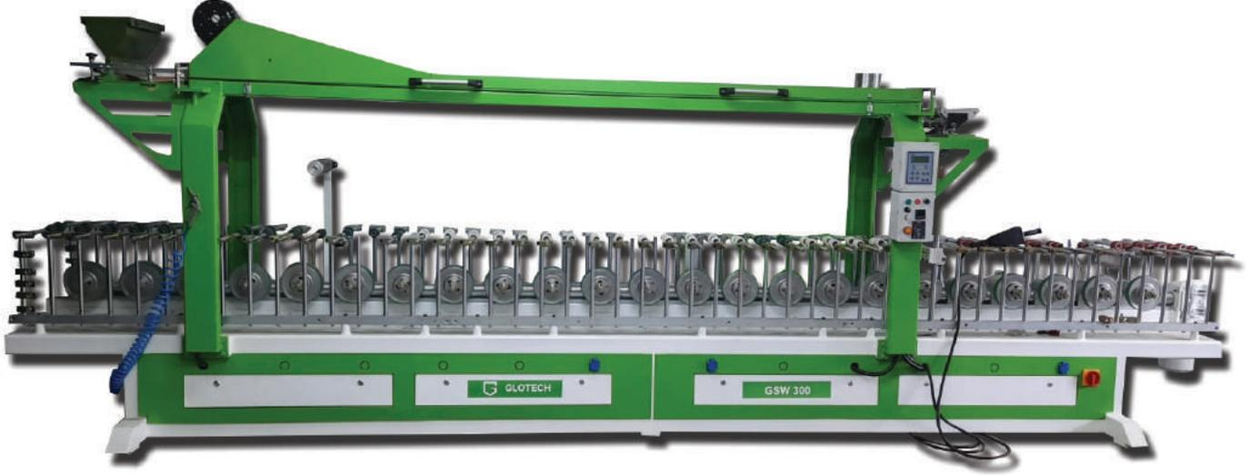
Alüminyum ve PVC kasa, kanat, orta kayıt, çıta profilleri üzerine PVC, PP, Kağıt folyolar kaplamak için kullanılır. Makine çift komponentli solvent tutkal uygulamalı dizayn edilmiştir. Bu tip makineler monoblok olarak tasarlanır. Talep edildiği halde makineye otomatik kesme modülü de entegre edilebilir.
