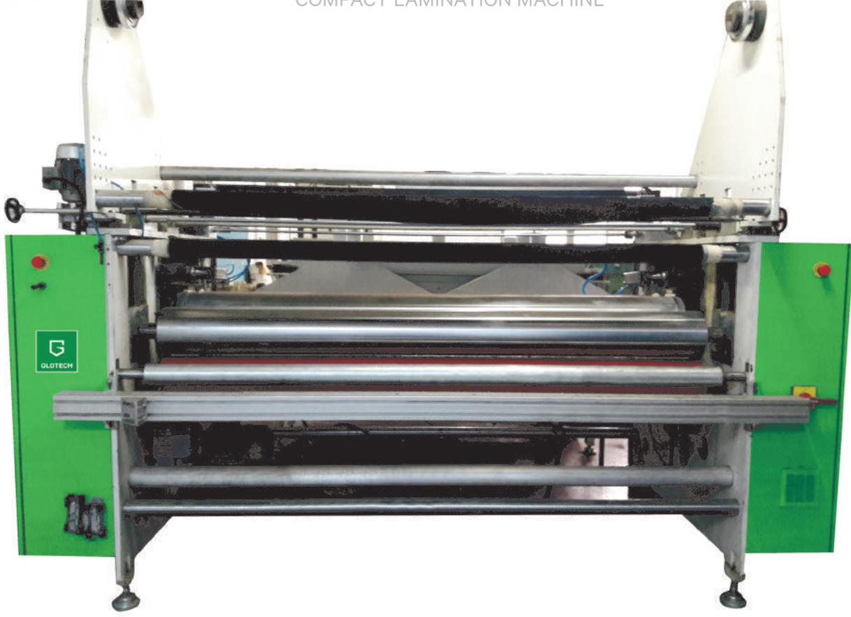
MDF, Compact, Ahşap, Kompozit Paneller üzerine PVC, PP, High Gloss – rulo folyolar kaplamak için kullanılır. Kaplanmış malzemeler aynı makinede baskı merdanesi ile preslenerek lamine edilir.
