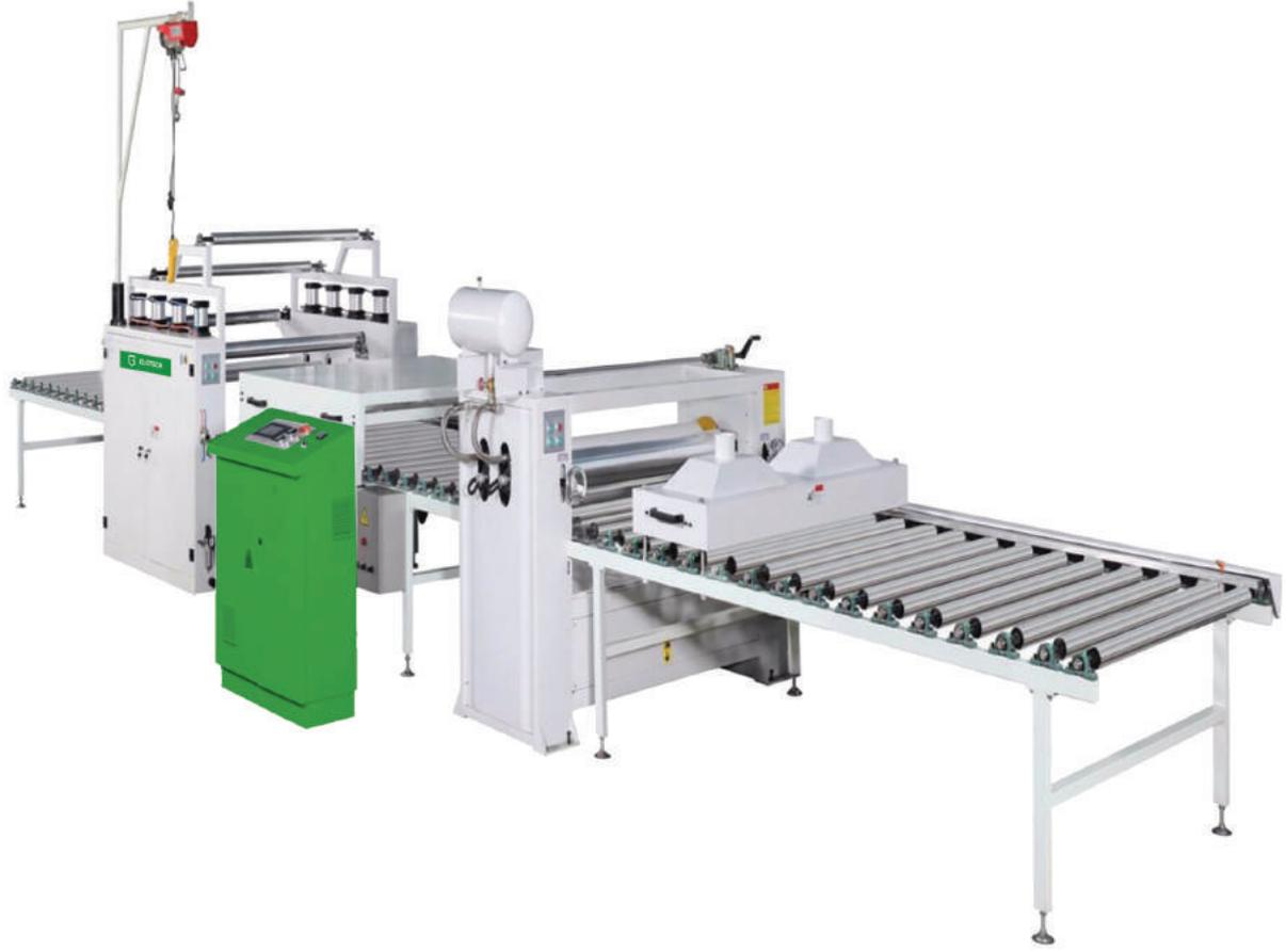
MDF, Compact, Ahşap, Kompozit Paneller üzerine High Gloss, Akriklik, PVC, PP, Kağıt ve diğer – rulo ve plaka folyolar kaplamak için kullanılır. Standart olarak 1400-2200 mm ve diğer farklı ölçülerde yapılabilir.
