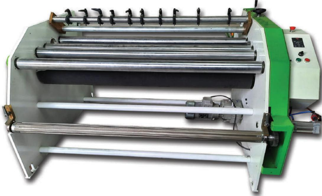
İç veya dış mekan PVC, PP, Kağıt, Mikrolaminat, PVC Kenar Bandı folyoları kesmek için kullanılır. İster disk bıçaklı, ister sanayi maket bıçaklı isterse de daire testere ile yapılabilir.
