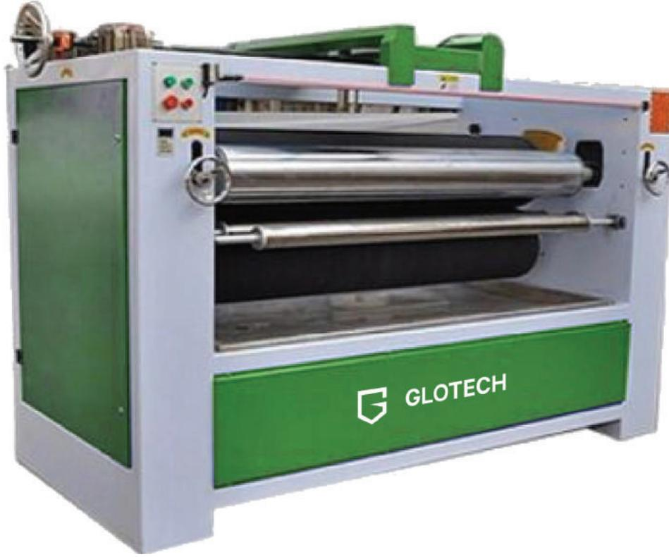
MDF, Compact, Ahşap, Kompozit Paneller üzerine Poliüretan, Üreformaldehit, PVA tutkalı sürmek kullanılır. Tek ve ya çift yüzey tutkal sürmeli olarak üretilebilir. Tutkal Sürme Makinesi High Gloss kaplamalarda pürüzsüz yüzey elde etmek için ters dönen "Reverse" Merdaneli olarak da yapılabilir.
