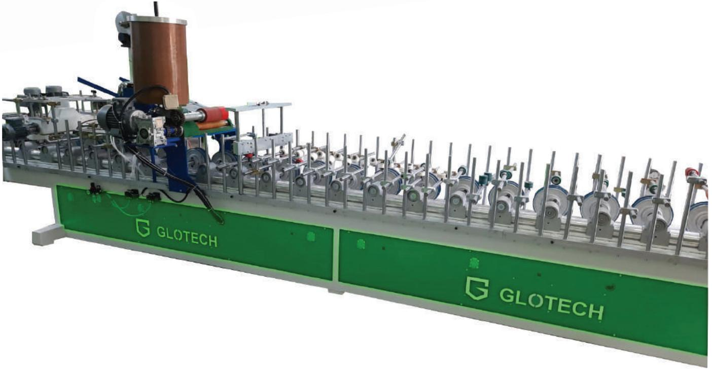
Kasa, Pervaz, Ahşap profiller üzerine Mikrolaminant, Doğal Ahşap folyolar kaplamak için kullanılır. Bu tip makineler monoblok veya kasetli olarak tasarlanabilir. Talep edildiği halde makineye otomatik kesme modülü de entegre edilebilir.
