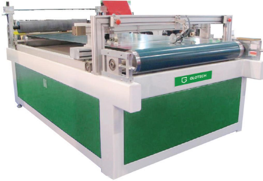
MDF, Compact, Ahşap, Kompozit Paneller üzerine kaplanmış rulo folyoların lamine olunduktan sonra kesilmesi için kullanılır. 2 eksen hareket mekanizmasına sahiptir. Konveyör üzerine monte edilecek şekilde tasarlanmıştır.
